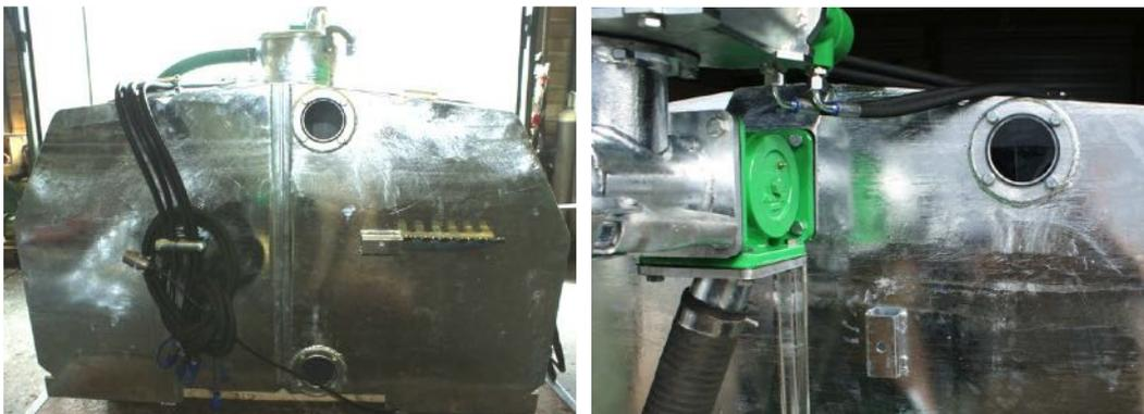
Abbildung: Bullaugen zur Überwachung des Füllstandes
